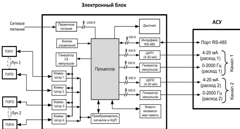
Рисунок 3.1 – Функциональная схема расходомера
