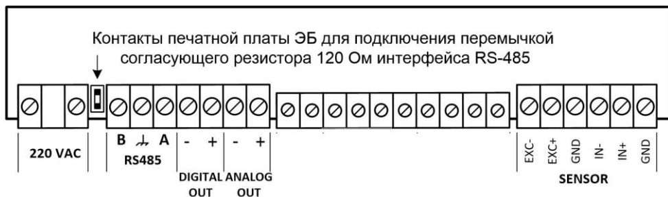
Рисунок Г.1 – Расположение контактов на клеммной колодке ЭБ (отдельное исполнение, перемычка для согласующего резистора не установлена)
