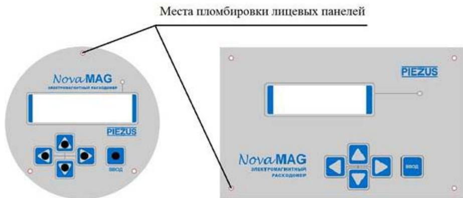
Рисунок 10.3 – Места пломбировки лицевой панели электронного блока
