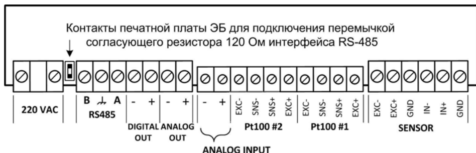
Рисунок Г.1 – Расположение контактов на клеммной колодке ЭБ (отдельное исполнение, перемычка для согласующего резистора не установлена)
