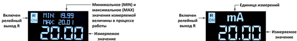
Примеры переключаемых экранов прибора
