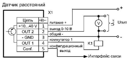
**Выход напряжения 0-10 В и один коммутатор (PNP)**
