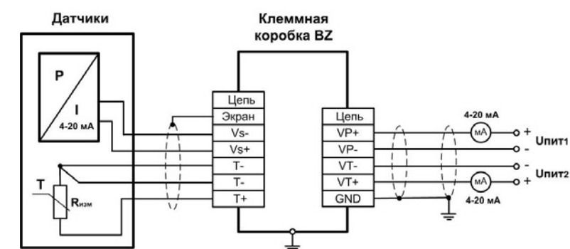
Рисунок А.3 – Схема подключения цепей
