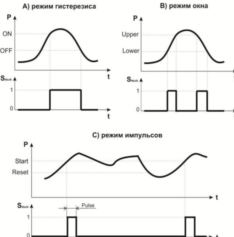
Рисунок 6 – Прямой режимы работы коммутационных выходов (S<sub>вых</sub>) при изменении входного давления (P)
