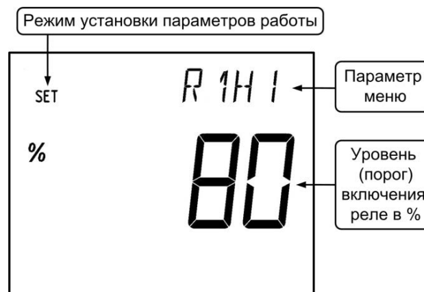
Рисунок 1 – Назначение отображаемых элементов дисплея в режиме настройки (программирования) параметров работы (R1HI – установка уровня сигнала для включения контактов SW1 реле)
