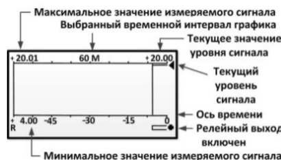
Рисунок 4 – Экран «graph» с графиком изменения сигнала (вертикальная шкала оси измеренных значений автоматически настраивается на удобное отображение диапазона измерений)
