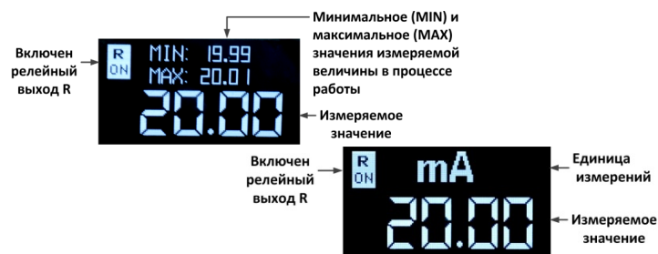
Рисунок 1 – Переключаемые экраны прибора, отображающие измеряемое значение
