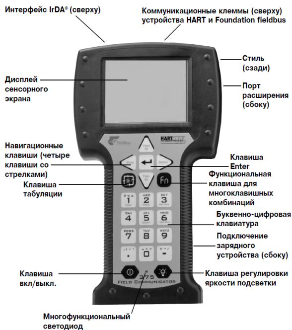
Рисунок Д.1 – Назначение элементов управления коммуникатора модели 375
