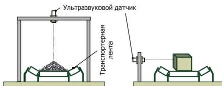
**Рисунок 6.2** – Примеры установки датчика на транспортной конвейерной ленте.
