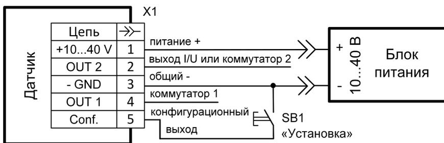
**Рисунок Б.2** – Подключение кнопки SB1 для настройки датчика по технологии Teach-IN (обучение по входному сигналу на объекте).
