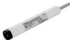
Погружной малогабаритный гидростатический датчик уровня ALZ 3710 для агрессивных сред. Прочный корпус из высокотемпературного полипропилена, поливинилхлорида (ПВХ) диаметром 21 мм или нержавеющей стали диаметром 17 мм и высококачественный керамический тензорезистивный сенсор обеспечивают высокую производительность для широкого спектра промышленных задач измерения уровня.
