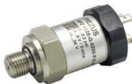
Высокоточный датчик давления APZ 1120 с погрешностью до  $\leq 0,4\%$  от измеренной величины на основе сенсора с разделительной мембраной из нержавеющей стали используются для работы в системах с низким энергопотреблением и автономным питанием. Благодаря специальной конструкции, ток потребления составляет не более 2 мА, при этом обеспечивается высокая точность измерений, надежность работы и быстрый выход на режим измерений.
