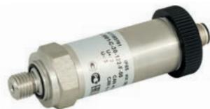
APZ 3426 – это датчик давления с высокостабильным кремниевым тензорезистивным чувствительным элементом со стальной мембраной. Датчик разработан специально для использования в промышленных сетях CAN. Модель доступна с выходными сигналами CANopen® и J1939.
