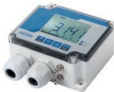
Датчик давления APZ 2035 специализированной серии с погрешностью до  $\leq 1,5\%$  от диапазона измерений на основе кремниевого тензорезистивного сенсора без разделительной мембраны. Алгоритм работы дискретных выходов (гистерезис или окно) и контролируемый интервал давлений выбираются пользователем при программировании. Наличие дисплея и кнопок управления позволяют оперативно производить все изменения настроек датчика давления без его демонтажа.
