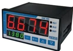
Индикатор обеспечивает цифровое отображение измерительной информации, передаваемой аналоговыми сигналами от различных датчиков и преобразование измеренной величины в нормированный аналоговый выходной сигнал тока 4...20 мА. Вход, выход и источник питания изолированы друг от друга. Изделие предназначено для установки в шкаф управления, имеет яркие светодиодные индикаторы и два программируемых релейных выхода. Настройка режима работы осуществляется с помощью кнопок, расположенных на лицевой панели.
