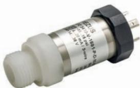
Датчик давления предназначен для применения в системах автоматизации судостроения в жестких условиях эксплуатации. Используемые в конструкции материалы и открытая мембрана сенсора позволяют работать с химически агрессивными и вязкими средами. Чувствительный элемент выполнен на основе сенсора с керамической разделительной мембраной, что дает устойчивость к перегрузкам и долговременную стабильность характеристик, при этом обеспечивается основная погрешность не более 0,5% от диапазона измерений.
