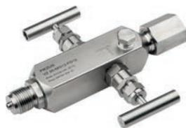
Вентильные блоки широко используются для подачи рабочей среды к датчику давления и обеспечивают удобство подключения различных преобразователей давления к обычным и импульсным линиям в системах управления технологическими процессами в промышленности. При проведении технического обслуживания блоки коммутации рабочей среды упрощают калибровку датчика.
