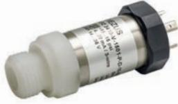
APZ 3410 – это датчик на основе керамического тензорезистивного чувствительного элемента, предназначенный для измерения давления агрессивных\* сред. Опционально штуцер может быть выполнен из пластика, а варианты исполнения с открытой мембраной и открытым портом позволяют датчику работать с вязкими и абразивными средами. Чувствительный элемент, примененный в датчике, не содержит масла, что также позволяет использовать его для работы со средами с высоким содержанием кислорода.
