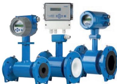
Электромагнитный расходомер NovaMAG, обладающий высокой точностью и стабильностью измерений. Обладает встроенной функцией самоочистки электродов для предотвращения нарастания отложений, способных повлиять на точность измерений. Доступна опция выходного сигнала с интерфейсом HART®. Выпускается с широким выбором условий исполнения. Доступны на выбор фланцевое, гигиеническое и присоединение типа «сэндвич». Может иметь до двух входов для датчиков температуры и один вход для датчика давления.
