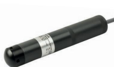
Высокоточный погружной датчик уровня ALZ 3824 с погрешностью до  $\leq 0,1\%$  от диапазона измерений в корпусе из поливинилхлорида ПВХ на основе сенсора с разделительной мембраной из нержавеющей стали, для измерения уровня сред, неагрессивных к нержавеющей стали и стандартным материалам уплотнения. Обеспечивает высокую долговременную стабильность и низкую дополнительную температурную погрешность во всем диапазоне рабочих температур. В датчике уровня реализовано разъемное кабельное соединение.
