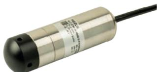
Погружной датчик уровня ALZ 3740 с погрешностью до  $\leq 0,25\%$  от диапазона измерений на основе емкостного сенсора с керамической мембраной. Открытая керамическая мембрана и высокая перегрузочная способность сенсора позволяют измерять уровни агрессивных и вязких сред. Опционально оснащается температурным датчиком Pt100.
