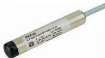
Погружной малогабаритный датчик уровня ALZ 3920 с погрешностью до  $\leq 0,2\%$  от диапазона измерений на основе сенсора с разделительной мембраной из нержавеющей стали, для измерения уровня сред, неагрессивных к нержавеющей стали стандартным материалам уплотнения. Диаметр корпуса датчика составляет 21 мм, что позволяет измерять уровень жидкости в ограниченном пространстве, например в скважинах. Опционально оснащается температурным датчиком Pt100.
