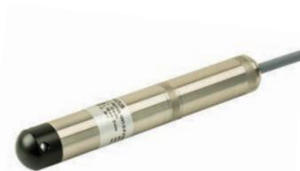
Высокоточный погружной датчик уровня ALZ 3821 с погрешностью до  $\leq 0,1\%$  от диапазона измерений на основе сенсора с разделительной мембраной из нержавеющей стали, для измерения уровня сред, неагрессивных к нержавеющей стали и стандартным материалам уплотнения. Обеспечивает высокую долговременную стабильность и низкую дополнительную температурную погрешность во всем диапазоне рабочих температур. Разъемное кабельное соединение облегчает обслуживание и замену датчика уровня на объекте.
