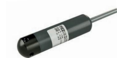
Бюджетный погружной датчик уровня ALZ 2712 с погрешностью  $\leq 0,5\%$  от диапазона измерений. Датчик используется для измерения уровня жидкости в том числе агрессивной (например, морская вода). Прочный корпус из ПВХ (PVC) или высокотемпературного полипропилена (PP-HT) диаметром 27 мм и высококачественный керамический тензорезистивный сенсор позволяют использовать прибор для измерения уровня в широком спектре задач.
