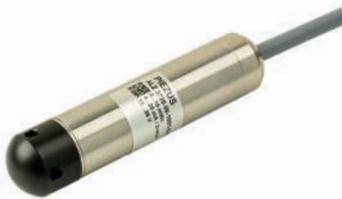
Погружной датчик уровня для применения в системах автоматизации в судостроении с погрешностью  $\leq 0,2\%$  от диапазона измерений, выполнен на основе сенсора с разделительной мембраной из нержавеющей стали позволяет измерять уровень неагрессивных\* к нержавеющей стали и стандартным материалам уплотнения сред (например, вода, некоторые виды топлива и др.) Опционально оснащается температурным датчиком Pt100.
