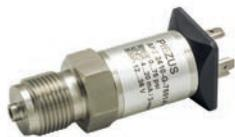
Датчик давления APZ 2410 OEM серии для общепромышленного применения с погрешность до  $\leq 1\%$  от диапазона измерений на основе сенсора с керамической мембраной. Может изготавливаться в многодиапазонном исполнении. Для переключения диапазонов и корректировки нулевого значения используется конфигуратор ZCON 100 (поставляется отдельно).
