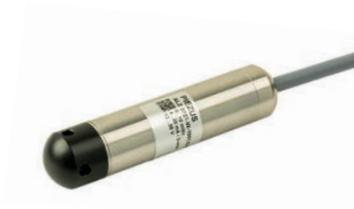
Погружной датчик уровня ALZ 3721 с погрешностью до  $\leq 0,1\%$  от диапазона измерений на основе сенсора с разделительной мембраной из нержавеющей стали для измерения уровня сред, неагрессивных к нержавеющей стали и стандартным материалам уплотнения (например, вода, топливо). Обеспечивает высокую долговременную стабильность и низкую дополнительную температурную погрешность во всем диапазоне рабочих температур. Опционально оснащается температурным датчиком Pt100.
