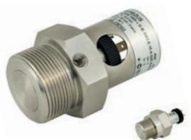
Датчик давления APZ 3420 v с поршневым разделителем в резьбовом исполнении применяется для непрерывных измерений давления пульпы, бурового раствора, бетона, шлама, ила, иных сред с песком, грунтом, каменной крошкой и другими твердыми включениями. Особо прочная толстая поршневая мембрана устойчива к ударам и допускает механическую очистку.
