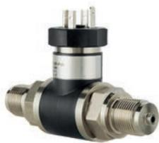
APZ 3020 - это общепромышленный датчик перепада давлений на основе кремниевого тензорезистивного чувствительного элемента, отличающийся возможностью измерений небольших перепадов давлений при высоком (до 4 МПа) статическом давлении. Компактный дизайн, различные варианты механических присоединений и их ориентации (аксиальное, радиальное) позволяют использовать прибор в ограниченном пространстве.
