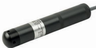
Погружной датчик уровня ALZ 3822 с погрешностью до  $\leq 0,2\%$  от диапазона измерений в корпусе из поливинилхлорида (ПВХ) на основе сенсора с разделительной мембраной из нержавеющей стали, для измерения уровня сред, неагрессивных к нержавеющей стали и стандартным материалам уплотнения (например, вода). В датчике уровня реализовано разъемное кабельное соединение, облегчающее обслуживание и замену датчика на объекте.
