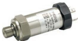
APZ 3421 - это высокоточный датчик давления с высокостабильным кремниевым тензорезистивным чувствительным элементом. Активная термокомпенсация и линейаризация чувствительного элемента обеспечивает низкую погрешность измерений в рабочем диапазоне температур. В сочетании с широким спектром опций, таких как цифровой дисплей и различные аналоговые и цифровые сигналы, это позволяет данному датчику находить применение во многих отраслях промышленности.
