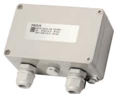
Клеммная коробка серии BZ предназначена для использования с погружными преобразователями давления, оснащенными гидрометрическим кабелем и термометром сопротивления Pt100. Атмосферное давление подается в капиллярную трубку кабеля через специальный воздушный фильтр корпуса коробки. Обеспечивается защита подключенного датчика от разрядов молнии и бросков напряжения.
