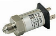
Датчик давления APZ 2422 серии OEM с погрешностью  $\leq 0,5\%$  от диапазона измерений предназначен для общепромышленного применения и объектов ЖКХ. Сенсор с разделительной мембраной из нержавеющей стали, установленный методом приварки, позволяет использовать этот датчик давления в промышленном холодильном оборудовании. Изготавливается в многодиапазонном исполнении. Для переключения диапазонов и корректировки нулевого значения используется конфигуратор ZCON 100 (поставляется отдельно).
