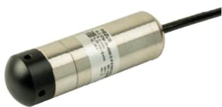
Погружной датчик уровня для применения в системах автоматизации судостроения с погрешностью до  $\leq 0,25\%$  от диапазона измерений на основе емкостного сенсора с керамической мембраной.
