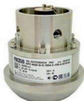
APZ 4420 – это датчик давления со штуцером Hammer Union. Монолитный штуцер предотвращает изменение характеристик датчика при монтаже в суровых условиях эксплуатации. Тонкопленочный тензорезистивный сенсор обеспечивает малый дрейф и высокую долговременную стабильность. Датчик давления особо устойчив к сильной вибрации, ударам и скачкам давления. Надежен при применении в процессах цементирования и затяжки затрубного пространства в стволах скважин.
