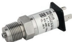
Датчик давления APZ 2422 d OEM серии с погрешностью ≤0,5% от диапазона измерений для применения в системах учета тепла и измерения расхода жидкостей газов. Сенсор с разделительной мембраной из нержавеющей стали установлен методом приварки.
