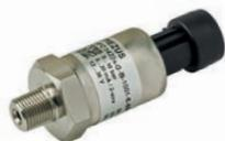
APZ 2422 a – это малогабаритный датчик давления, предназначенный в первую очередь, для поставки OEM производителям минимальными товарными партиями в 50 шт. по специальной цене. В датчике применен кремниевый тензорезистивный чувствительный элемент. Сварное соединение чувствительного элемента и штуцера позволяет применять прибор в приложениях, где недопустимо применение уплотнения на основе эластомеров. Модель поддерживает корректировку нулевого значения при помощи конфигуратора ZCON 100\*.
