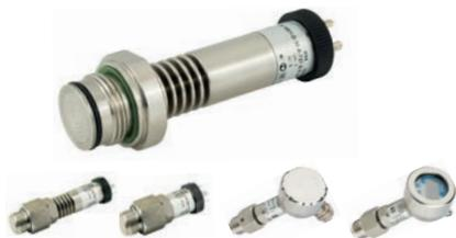
APZ 3420 m – это датчик давления, оснащенный разделителем сред с торцевой мембраной. Опционально выполняется с разделителем-радиатором, заполненным высокотемпературным силиконовым маслом. Предназначен для измерения давления вязких, пастообразных и/или высокотемпературных сред.
