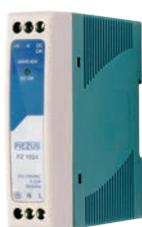
Промышленный блок питания в пластиковом корпусе для монтажа на DIN-рейку. Изделие является электронным импульсным преобразователем сетевого переменного (или постоянного) напряжения, изменяющегося в широком диапазоне, в стабилизированное постоянное напряжение 24 В. Имеет встроенный входной фильтр и обеспечивает гальваническую изоляцию цепей входа и выхода не менее 3 кВ.
