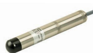
Погружной датчик уровня ALZ 3820 с погрешностью до  $\leq 0,2\%$  от диапазона измерений на основе сенсора с разделительной мембраной из нержавеющей стали, для измерения уровня сред, неагрессивных к нержавеющей стали и стандартным материалам уплотнения (например, вода, некоторые виды топлива).
