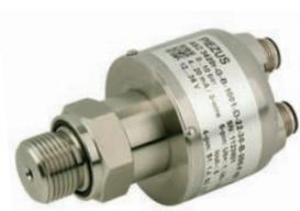
ASZ 3420 r – это электронное реле давления на основе кремниевого тензорезистивного чувствительного элемента с двумя независимыми релейными выходами типа «сухой контакт». Благодаря возможности конфигурирования\* пределов срабатывания, режимов работы, величины гистерезиса и задержки переключений, прибор является универсальным устройством для управления исполнительными устройствами. Помимо дискретных выходов, реле имеет аналоговый выходной сигнал 4-20 мА / 3-х пров.
