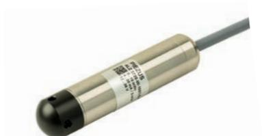
Погружной датчик уровня ALZ 3720 с погрешностью до  $\leq 0,2\%$  от диапазона измерений на основе сенсора с разделительной мембраной из нержавеющей стали, для измерения уровня сред, неагрессивных к нержавеющей стали и стандартным материалам уплотнения (например, вода, некоторые виды топлива).
