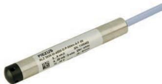
Погружной малогабаритный датчик уровня ALZ 3925 с погрешностью до  $\leq 0,2\%$  от диапазона измерений на основе сенсора с разделительной мембраной из нержавеющей стали, для измерения уровня сред, неагрессивных к нержавеющей стали и стандартным материалам уплотнения (например, вода, некоторые виды топлива). Диаметр корпуса датчика составляет 17 мм, что позволяет измерять уровень жидкости в скважине. Опционально оснащается температурным датчиком Pt100.
