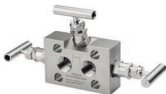
Вентильные блоки широко используются для подачи рабочей среды к датчику давления и обеспечивают удобство подключения различных преобразователей давления к обычным и импульсным линиям в системах управления технологическими процессами в промышленности. При проведении технического обслуживания блоки коммутации рабочей среды упрощают калибровку датчика.
