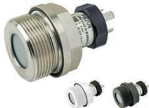
APZ 3240 – это датчик на основе высокоточного керамического емкостного чувствительного элемента. Его особенностью является открытая мембрана, что позволяет применять его для измерения давления вязких и абразивных сред. Для измерения давления или уровня агрессивных\* сред штуцер прибора может быть выполнен из пластика. Чувствительный элемент, примененный в датчике, не содержит масла, что также позволяет использовать его для работы со средами с высоким содержанием кислорода.
