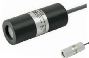
Погружной датчик уровня ALZ 3742 с погрешностью до  $\leq 0,25\%$  от диапазона измерений на основе емкостного сенсора с керамической мембраной в пластиковом корпусе.
