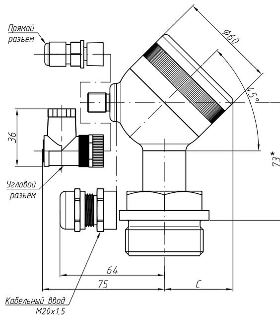
\*С выходным сигналом RS485 / ModbusRTU корпус датчика длиннее на 34 мм.
