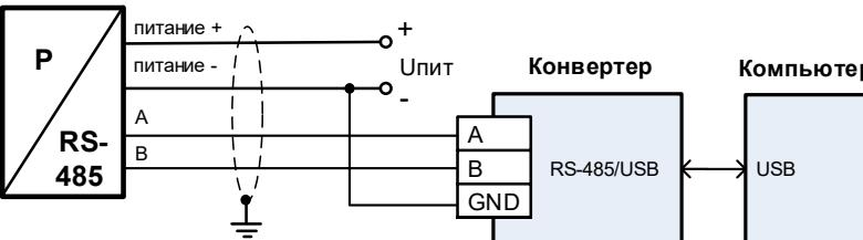
**Рисунок 2 – 4-проводная линия (выходной сигнал – RS-485)**
