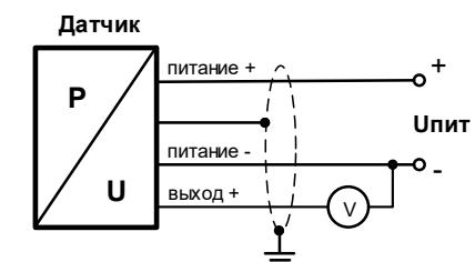
3-проводная линия (выходной сигнал – напряжение)
